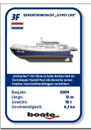
Seltsame Seefahrt, Teil 22: Bei Smelne im niederländischen Drachten ließ Extremskipper Harald Paul 2004 einen Stahlverdränger bauen und speziell für Expeditionstörns in hohe Breiten ausrüsten. So verfügt das ursprüngliche Serienboot etwa über einen tieferen Kiel mit Stahlplatte. verstärkte Isolierung und Fenster. Zu den Reisezielen gehörten bereits Spitzbergen, Grönland und momentan Kanada (siehe rechts).
